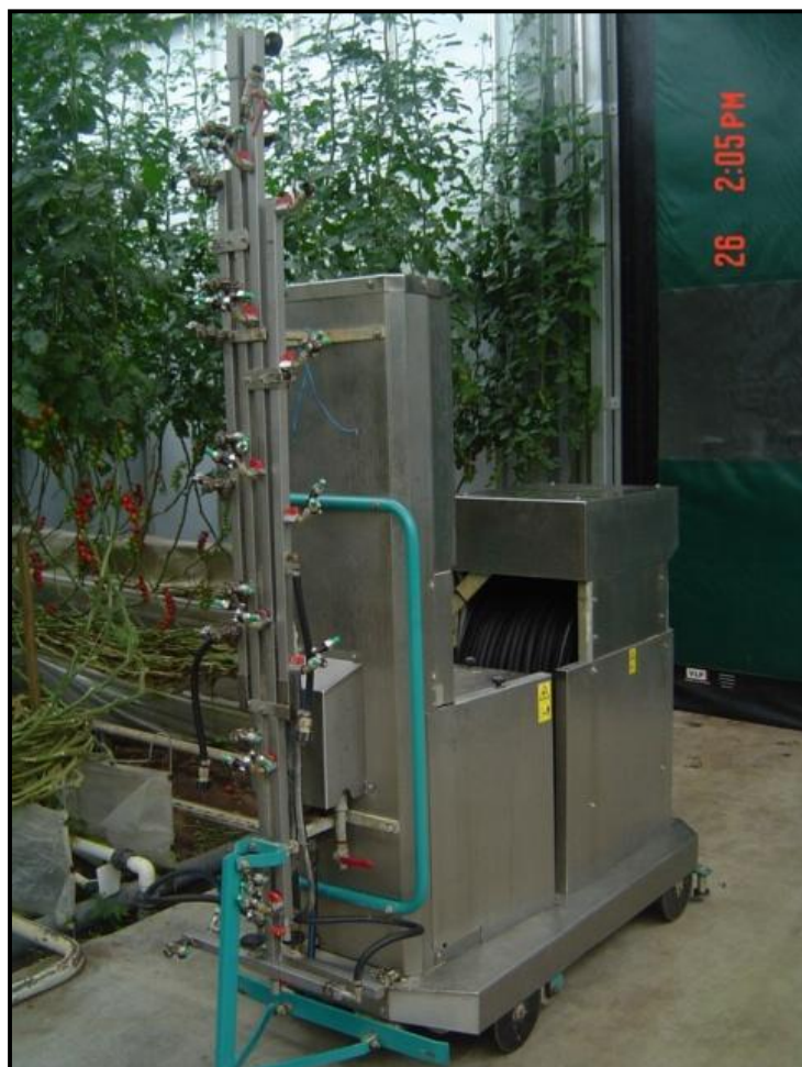
Figura 19 – Pulverizador robótico utilizado na Horticultura. Original
