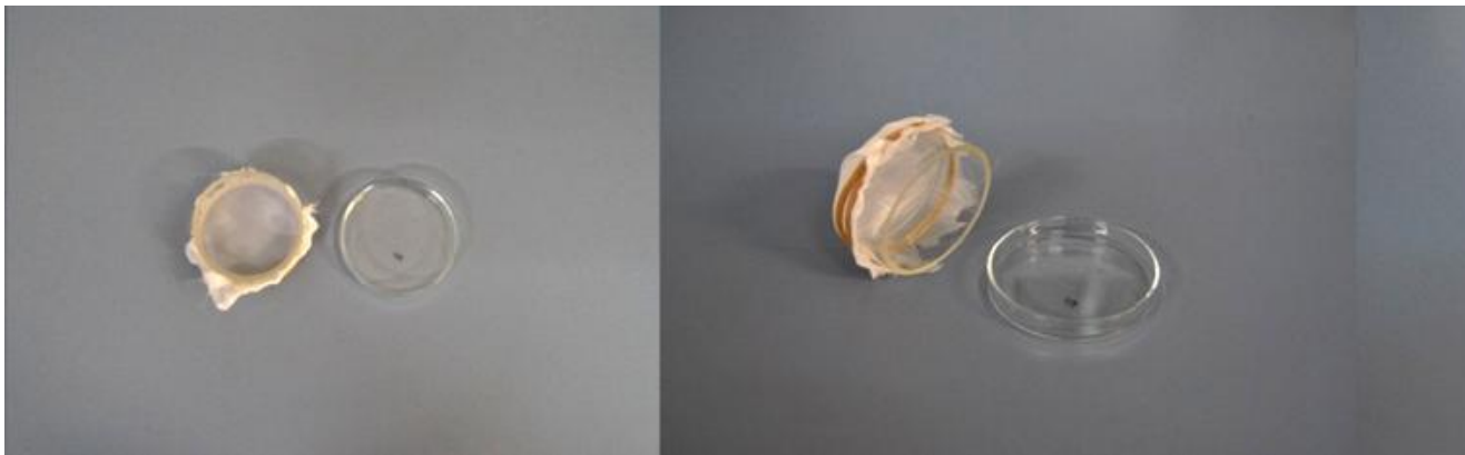
Figura 18 – Placas de Petri e anéis de vidro cobertos com rede utilizados no ensaio. Original do autor.
