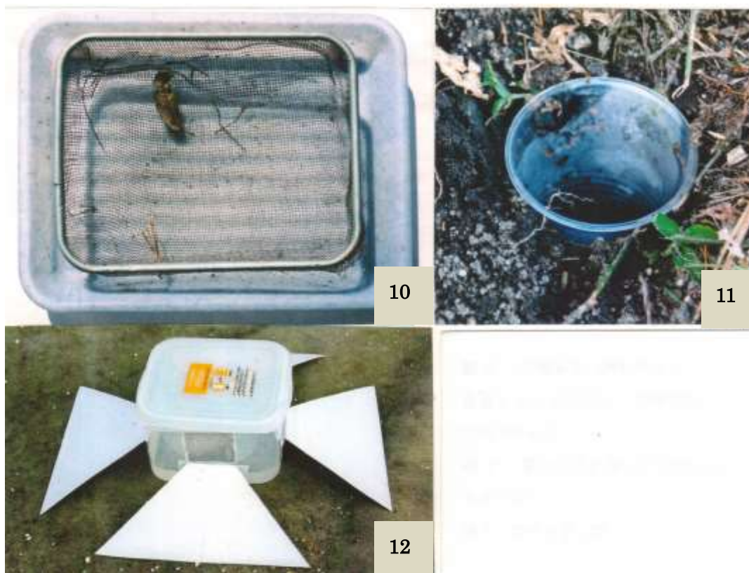
図 10. 土壌ふるい用のざるとトレイ。落葉層をざるでふるい、昆虫他の土壌動物をトレイに落とさせる。
