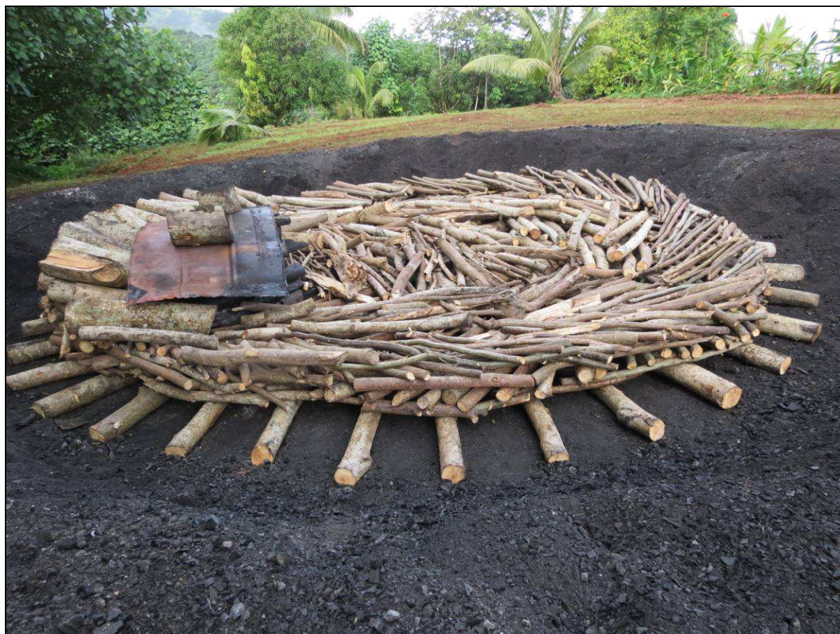
Meule de charbonnier en cours de constitution
